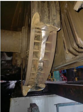
Pęknięcie koła w pojeździe SA136
