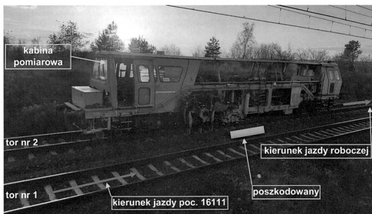
Zdjęcie 1 - Zdjęcie z dnia wypadku wykonane przez komisję kolejową
